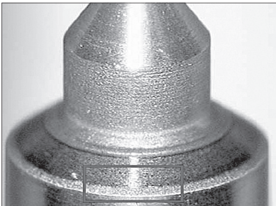
Fotografia 9. Uszkodzenia krawędzi uszczelniającej iglicy zaworu
